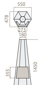
Materiaal: 2 mm staal gecoat, antraciet / matériau: 2 mm acier avec couche de protection, anthracite
