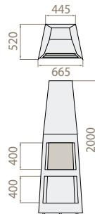
Materiaal: 4 mm staal gecoat, antraciet / matériau: 4 mm acier avec couche de protection, anthracite
